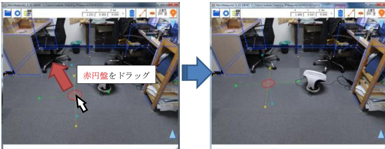
赤円盤をドラッグしたとき、仮想メジャーは同一水平面上を移動します。例えば、上図では仮想メジャーは床面上にあります。赤円盤をドラッグすると、仮想メジャーは床面上を水平に移動するわけです。
