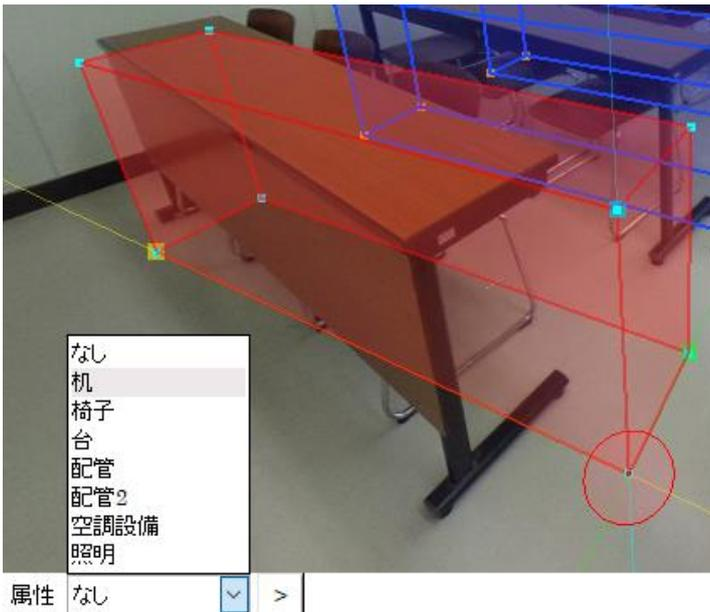
図形オブジェクトや一般グループを選択すると、最下行の左端に属性の入力欄が現れます。最初は「なし」となっているので、それを消して新しい属性を記入して「>」ボタンを押せば、記入した属性が選択した図形に付きます。一度設定した属性名は、リストに残って選択可能となります。属性リストは、プロジェクトフォルダ内の `classlist_ja.dat` というファイルに記載されるので、予めそのファイルにテキストエディタなどで属性リストを記載しておいたり、他のプロジェクトからコピーしてきたりすることもできます。なお、グループごとの属性については、`groupclass_ja.dat` というファイルに記載されます。
