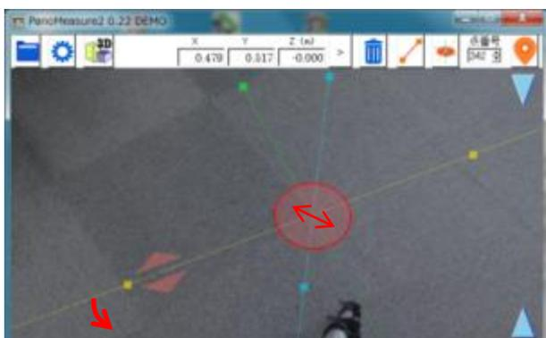
① タイルカーペットの端点に赤円盤中心を合わせて、軸の向きを合わせます。
