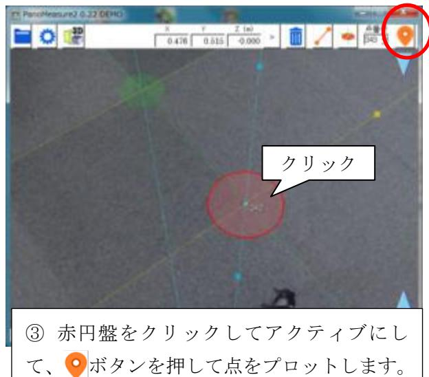
③ 赤円盤をクリックしてアクティブにして、
