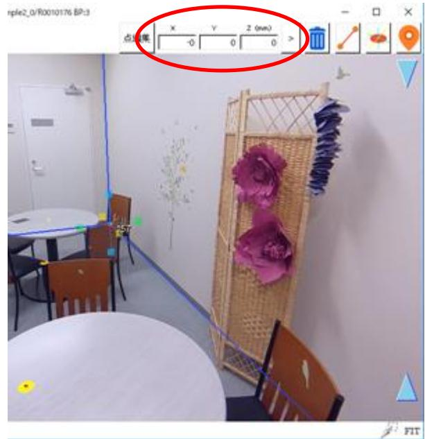
いずれも同じように、同じ BOX オブジェクトの端点の座標が  $(0, 0, 0)$  となっています。それぞれの写真が global レイヤー上の BOX オブジェクトに合わせるように座標変換された結果、このようになっているのです。
