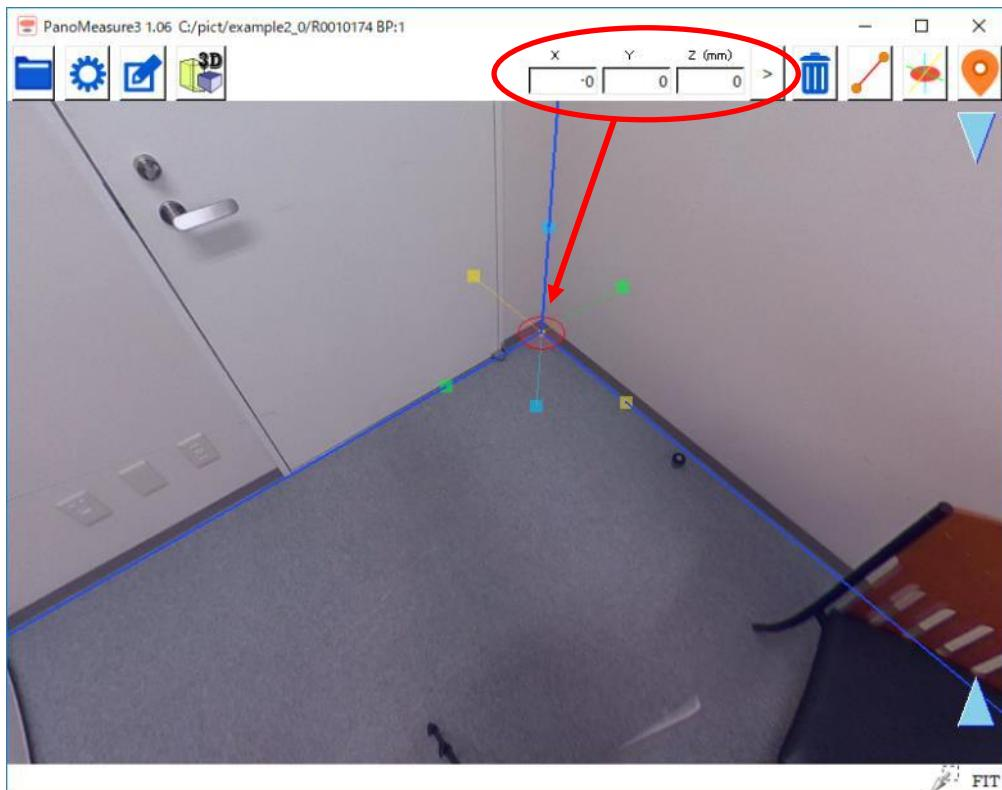
座標変換は自動的に行われ、目に見える処理がなされるわけではないので、実感することができませんが、BOX オブジェクトの端点位置の座標に注目して下さい。座標変換が行われると、仮想メジャー
