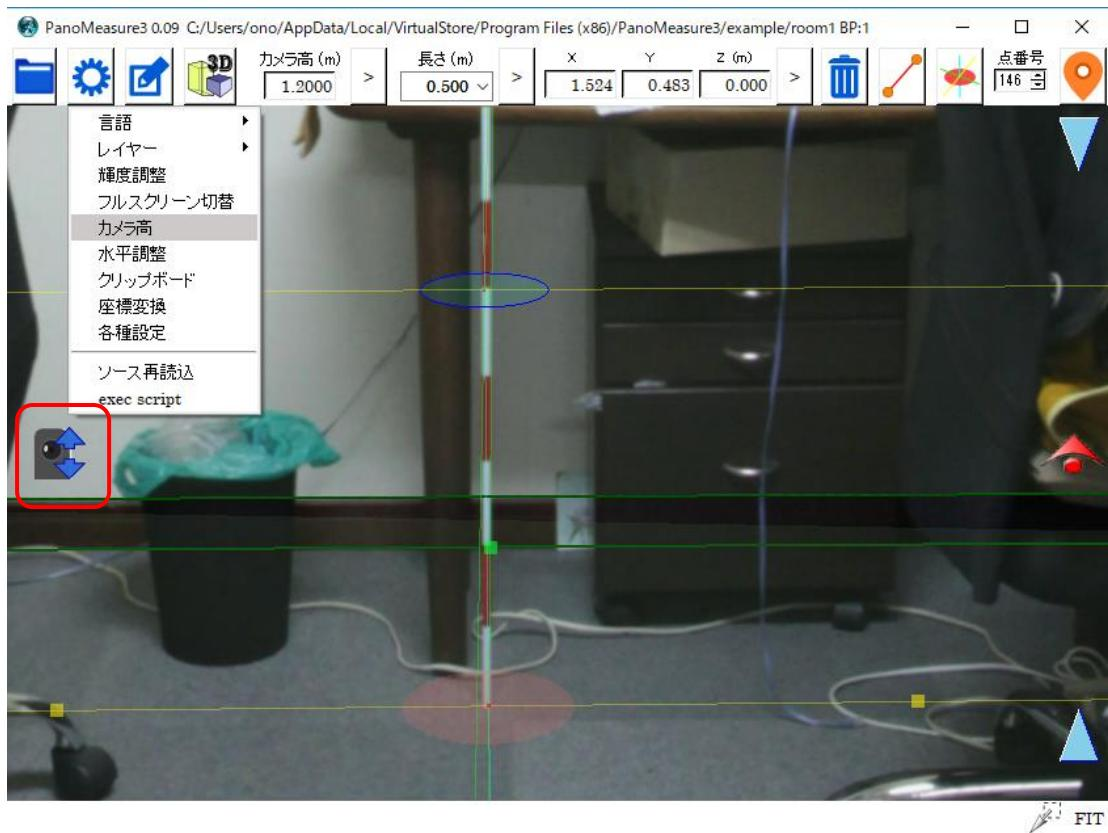
なお、このような短い長さをもとに調整するよりは、部屋の長手方向の長さを別途測っておき、その長さをもとにカメラ高を求めるというように、基準とする長さをできるだけ長くした方が高い精度でカメラ高を決定できます。
