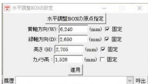
まず、水平調整用の BOX オブジェクトの原点位置を決めます。一番上に「水平調整 BOX の原点指定」ボタンがあるのでそれを押してください。原点指定モードに切り替わり、仮想メジャーの位置が画面中央に固定されます。「水平調整 BOX の設定」画面を閉じずに、画像をドラッグして、部屋の床の角に合わせてください。また、BOX の線分をクリックすると角度調節用の矢印が出てきます。BOX の方向も合わせておきましょう。位置が合ったら、BOX の設定画面のボタンを押せば原点位置が確定されます。
