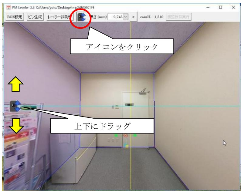
既知の寸法で BOX を表示させているときは、これと天井の高さが合うように調節してください。
