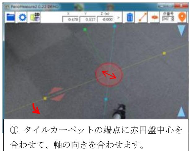
① タイルカーペットの端点に赤円盤中心を合わせて、軸の向きを合わせます。
