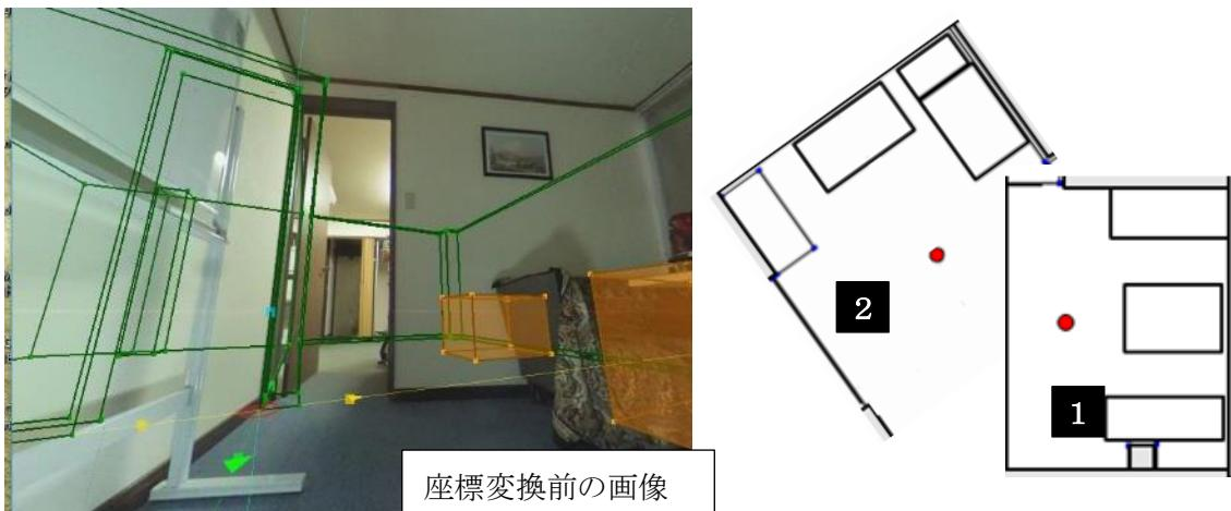
そこで、図面の座標と向きを統一するよう座標変換を行ないます。画像ごとに座標変換を行い、正しい位置に図面を配置していくことで、連続的に、座標と向きの統一された図面を描画していくことができます。
