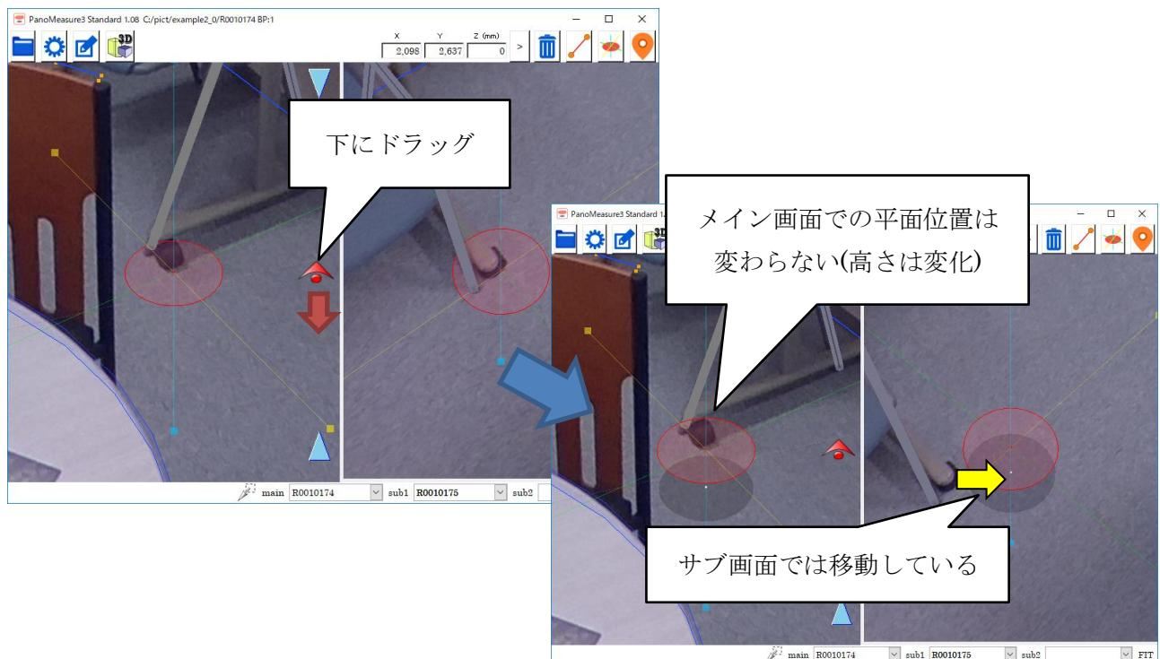
仮想メジャーの移動方法には、水平面内の移動、鉛直線上の移動、奥行方向の移動のほかに、鉛直平面内で移動する方法や座標を指定して移動する方法、計測点をクリックして移動する方法などがありますが、それらについては後で説明します。
