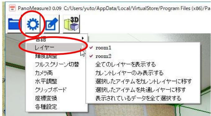
画面上に表示されているレイヤーは、レイヤー名の横に✓マークが付いています。レイヤー名をクリックすることで、表示・非表示の切り替えができます。「全てのレイヤーを表示する」を選べば、すべてのレイヤーが表示され、「カレントレイヤーのみを表示する」は現在開かれている画像に対応したレイヤーのみが表示状態になります。
