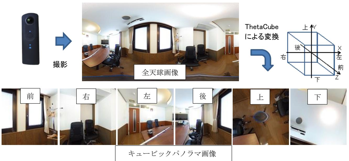
なお、同じ正距円筒図法の画像なら、THETA や insta360 以外のカメラで撮影した画像でも変換可能です。ただし、最適な解像度の画像に変換されない、カメラ情報をもとにした水平調整ができない、といったことが起きる可能性があります。
