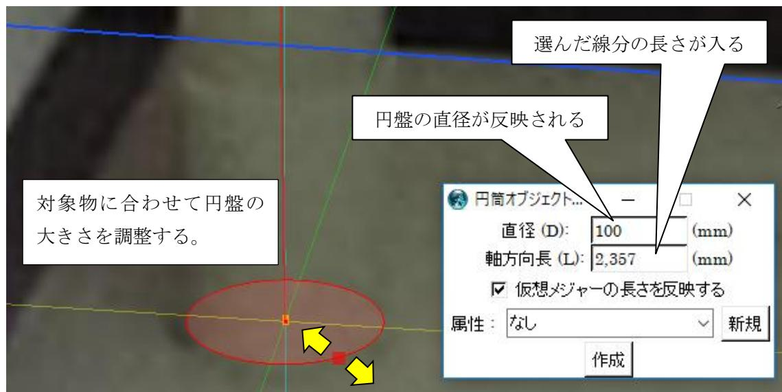
もちろん、直接直径を入力しても構いません。線分を選ぶと、軸方向長には選んだ線分の長さが入ります。ただ、線を利用する方法では軸方向長の欄に入力した値は反映されませんので、必要なら線分の端点を移動して長さの調整をするか、BOX オブジェクトのように仮想メジャーで長さを指定する方法を使ってください。
