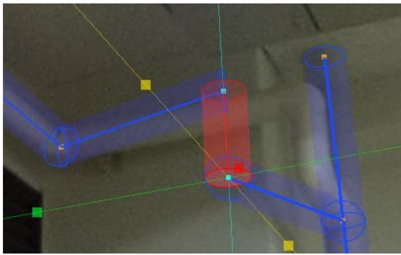
また、鉛直ではない円筒オブジェクトを選んだ場合、軸の水平方向に仮想メジャーの緑軸がフィットします。緑軸を回転させることで、円筒オブジェクトの水平方向の向きを変えることができます。
