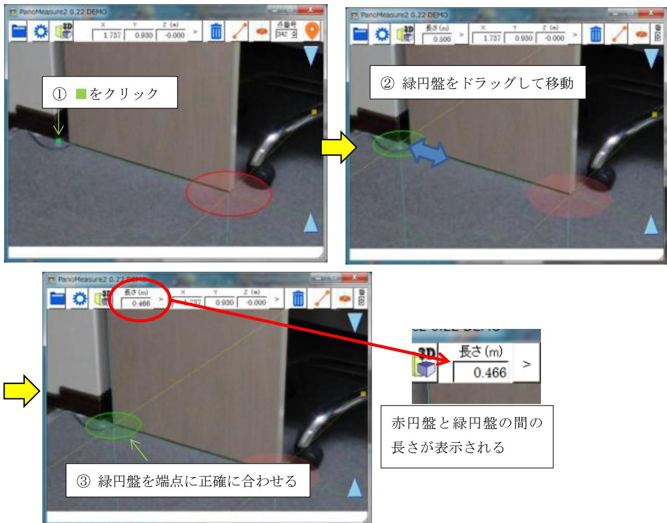
緑円盤を計測したい対象物のエッジの反対側の端点に正確に合わせます。緑円盤にも赤円盤と同じように緑軸に対して直交する2つの軸(黄色、水色)が現れるので、それらの軸を使ってエッジなどに沿うように正確に合わせてゆきます。メニューバーの「長さ(m)」に長さが表示されます。
