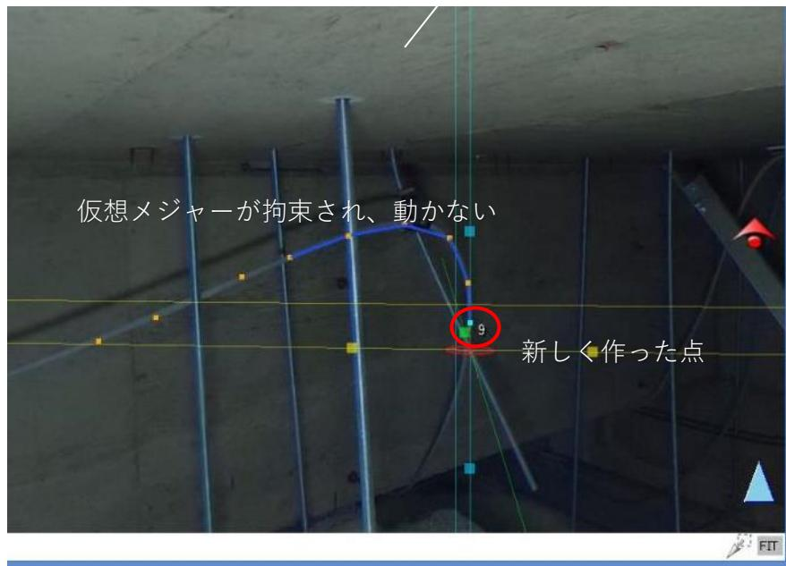
例えば、配管に合わせて曲線を描きたい時などに FIT 機能を ON にしていると
