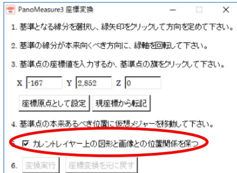
現在表示されている画像上で作図した図形（カレントレイヤーの図形）を画像とともに座標変換します。最後に「変換実行」を押せば完了です。
