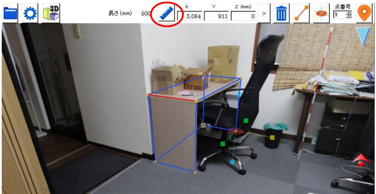
物差しマークをクリックすると、選択している線分上に長さが表示されます。
