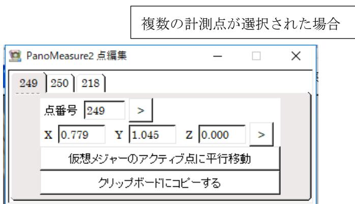
また、「仮想メジャーのアクティブ点に平行移動」ボタンを押すと、仮想メジャーの上のアクティブな円盤の中心位置に編集している点が移動します。
