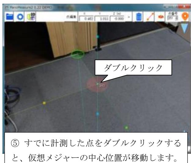
⑤ すでに計測した点をダブルクリックすると、仮想メジャーの中心位置が移動します。
