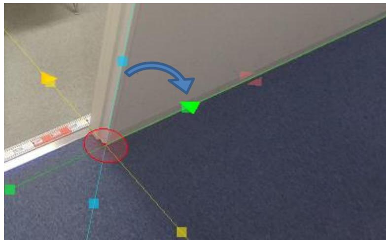
(9) 基準点の旗をクリックすると、座標変換ウィンドウの座標値入力欄に基準点の座標値が入る。
