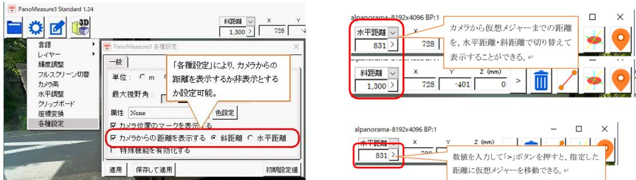
各種設定メニューから「カメラからの距離を表示する」を有効にすることで、カメラ位置から仮想メジャーまでの距離を表示させることができます。表示する距離は、斜距離(カメラ位置から仮想メジャーまでの距離)、水平距離(カメラ位置の高さ軸から仮想メジャーまでの水平距離)の2種類から選べます。
