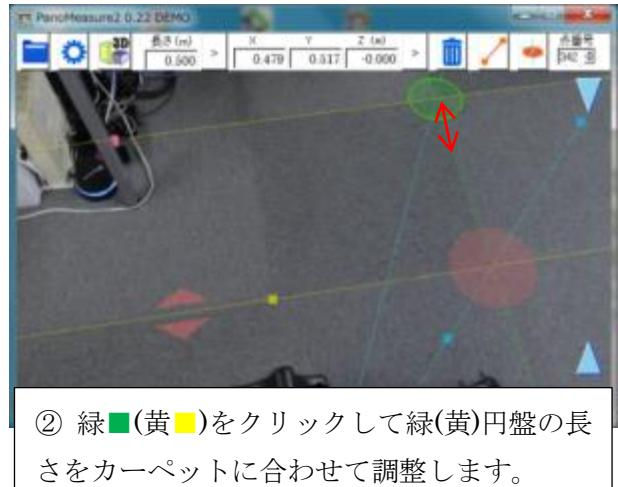
② 緑■(黄■)をクリックして緑(黄)円盤の長さをカーペットに合わせて調整します。
