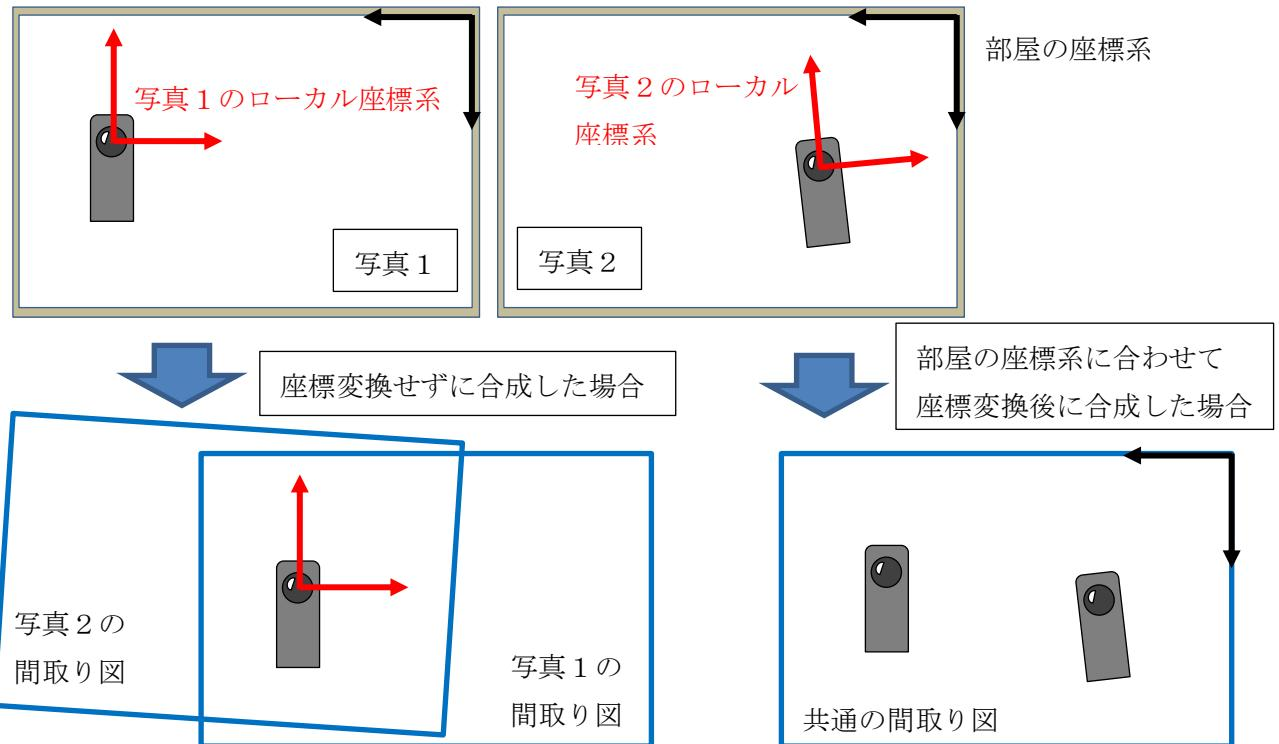
異なる部屋ごとに写真を撮影した場合には、このように自動的に座標変換を行うことはできません。そのため後で手動の座標変換を行います。詳しくは本マニュアル内「座標変換機能を用いた図面の統合」を参照して下さい。
