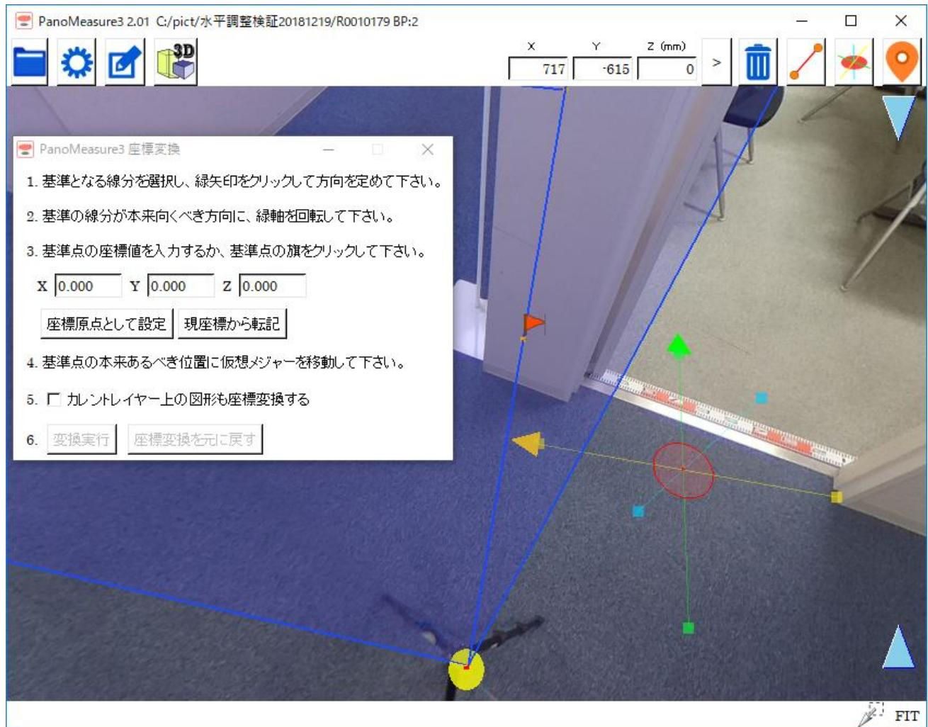
(6) 方向の基準とする線分（基準線）をクリックして選択。
