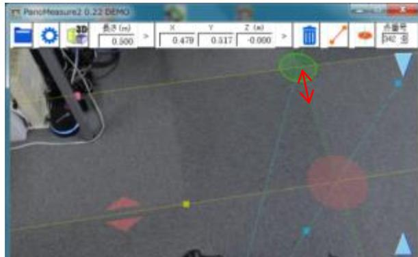
② 緑■(黄■)をクリックして緑(黄)円盤の長さをカーペットに合わせて調整します。
