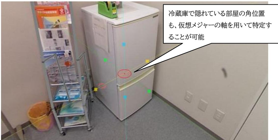
PM2 では、仮想メジャーと呼ばれる三次元ポインターをメインツールとして使用します。仮想メジャーとは、実空間上で巻き尺を当てて寸法などを計測するのと同じように、全天球画像によって表現される仮想空間内でメジャーを当てる要領で寸法計測するためのツールです。仮想メジャーは直交する3軸を持っており、その軸を利
