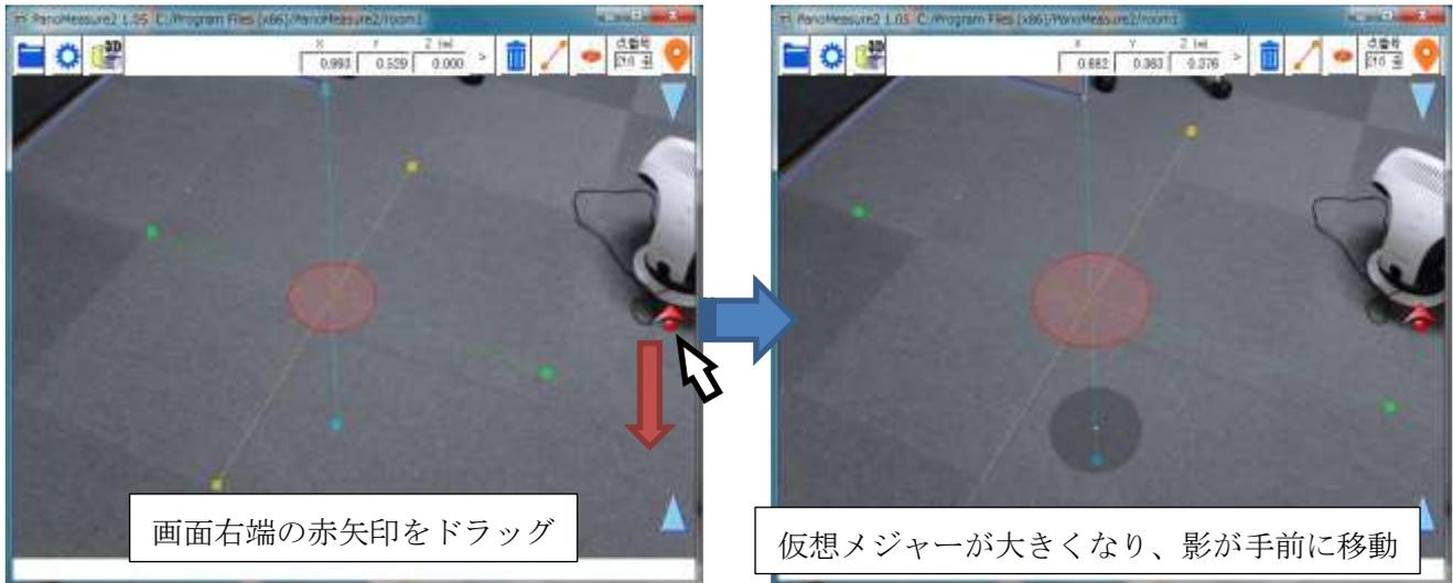
仮想メジャーの移動方法には、水平面内の移動、鉛直線上の移動、奥行方向の移動のほかに、鉛直平面内で移動する方法や座標を指定して移動する方法、計測点をクリックして移動する方法などがありますが、それらについては後で説明します。
