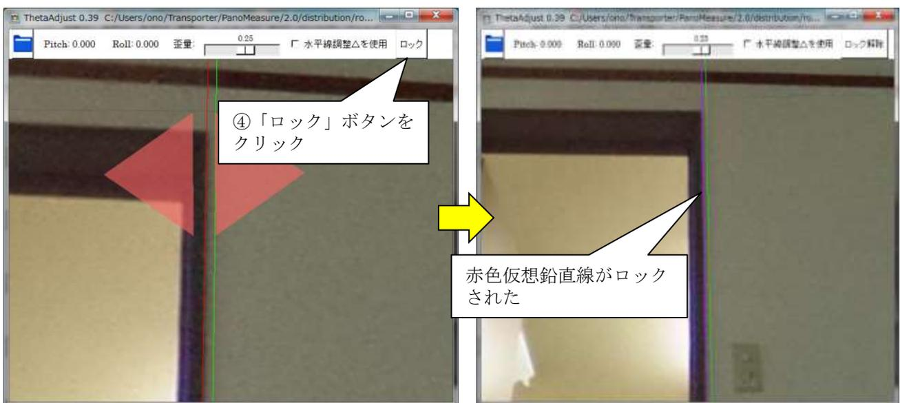
ウィンドウ右上の「ロック」ボタンを押すと、赤色仮想鉛直線（|）が紫色に変わりロックされた状態になります。ロックを解除するには、「ロック解除」ボタンを押して、紫色の仮想鉛直線を消します。別の赤色仮想鉛直線を表示させて、それをロックした場合は、すでにロックされた仮想鉛直線は消えます(複数の赤色仮想鉛直線をロックすることはできません)。
