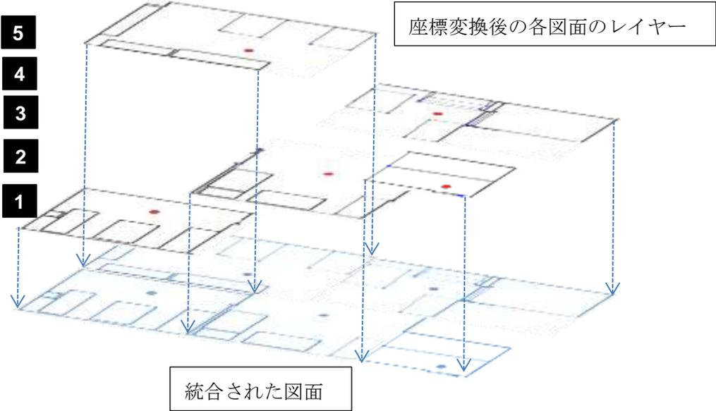
それだけでなく、ある画像を用いて作った図面を、隣接する場所で撮影した画像にインポートすれば、連続的に図面を繋げて作成してゆくことができるので、重複して作図することがなく、効率的に図面作成をすることができます。
