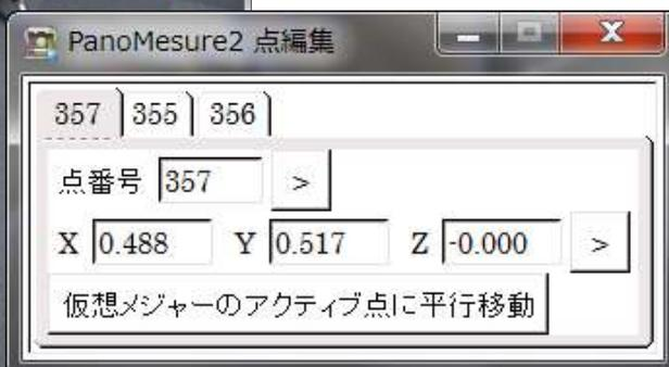
また、「仮想メジャーのアクティブ点に平行移動」ボタンを押すと、仮想メジャーの上のアクティブな円盤の中心位置に編集している点が移動します。
