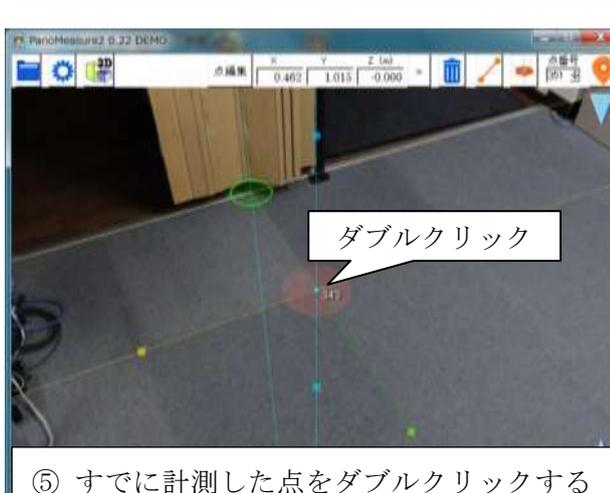
⑤ すでに計測した点をダブルクリックすると、仮想メジャーの中心位置が移動します。
