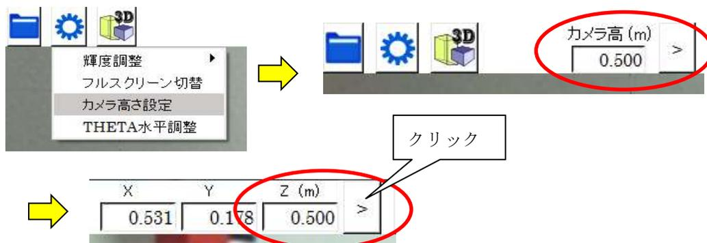
すると、仮想メジャーが設定されたカメラの高さに移動して水平な線として表示されます。この水平な線を使って、正しいカメラ高さをロッドなどから読み取ります。
