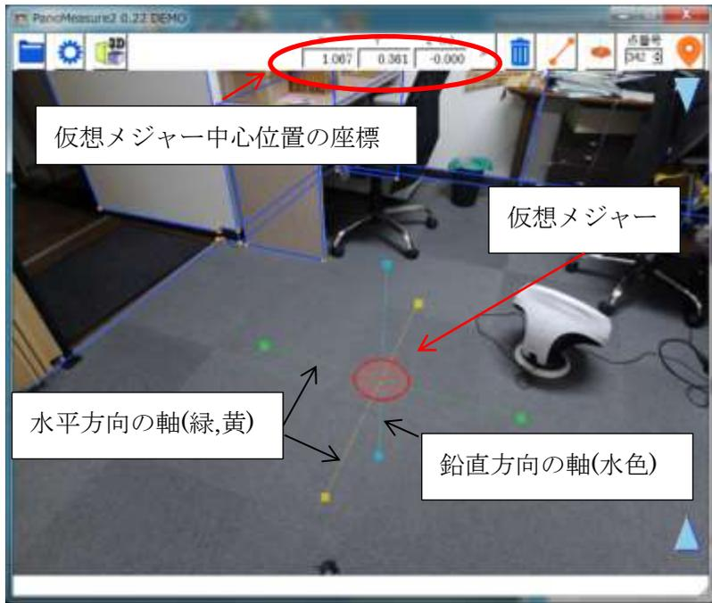
仮想メジャーを移動させるには、赤円盤をドラッグします。ドラッグしたまま画面の端に達すると、画像が自動的にスクロールします (赤円盤が画面の端にくる度に画像を動かさなくてもいいわけです)。
