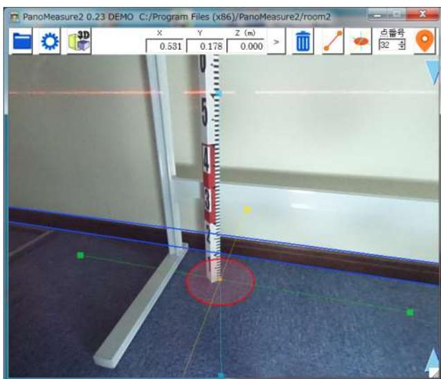
続いて、ツールメニューの「カメラ高さ設定」を選びます。すると、カメラ高(m)として、現在設定されているカメラ高さの値が表示されるので、その値を Z(m)の入力欄に転記して「>」ボタンをクリックします。
