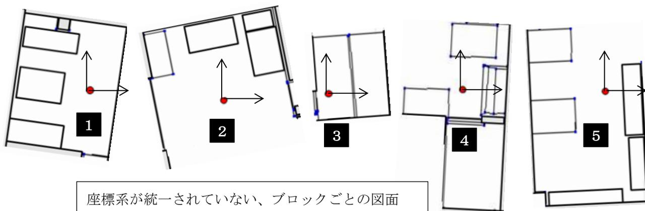
そこで、全てのブロックで座標系を統一するよう座標変換を行ないます。座標変換により、別々に作った図面であっても、CAD へ出力したときに、単純に各図面のレイヤーを重ね合わせるだけで、図面を統合することができます。
