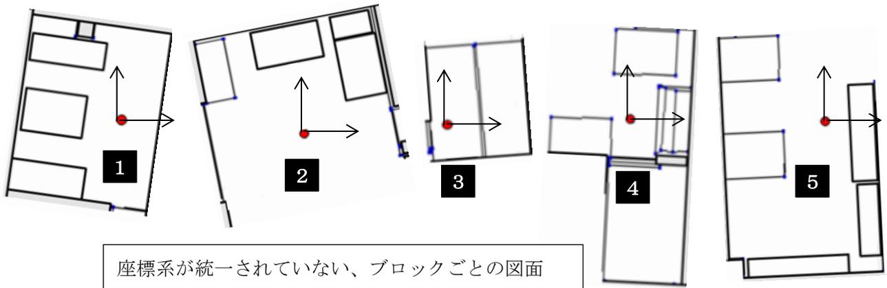
そこで、全てのブロックで座標と向きを統一するよう座標変換を行ないます。別々に作った図面であっても、座標変換により、座標と向きを統一したら CAD に出力したときに、単純に各図面のレイヤーを重ね合わせるだけで、図面を統合することができます。
