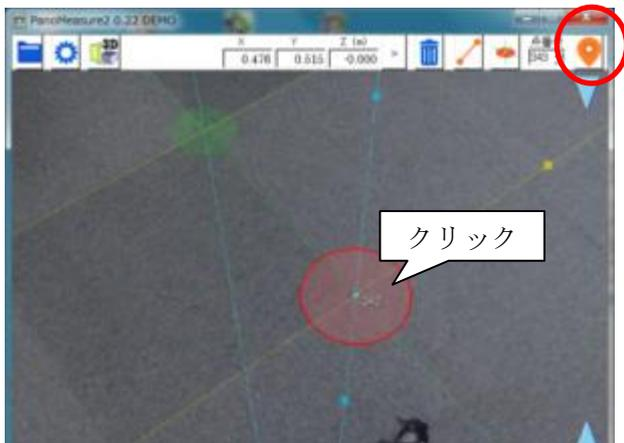
③ 赤円盤をクリックしてアクティブにして、📍ボタンを押して点をプロットします。
