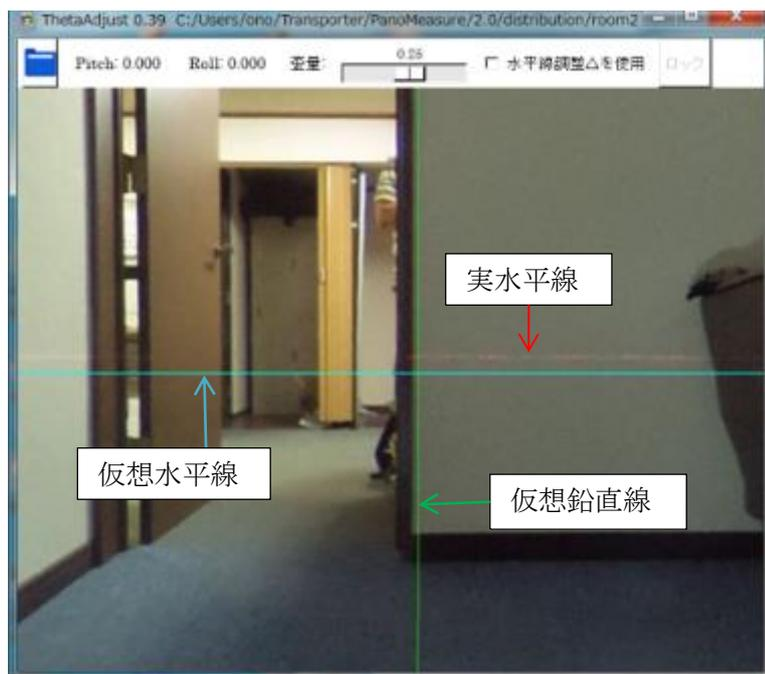
緑色の鉛直線と黄色色の鉛直線は直上で直行し、THETA の前後方向、左右方向を表す線になります。
