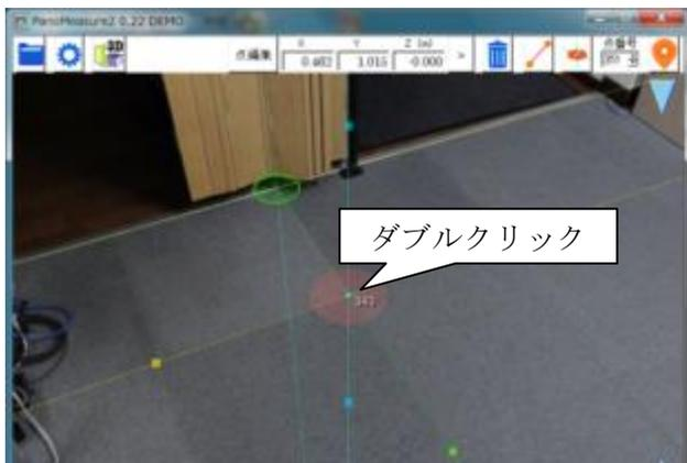
⑤ すでに計測した点をダブルクリックすると、仮想メジャーの中心位置が移動します。
