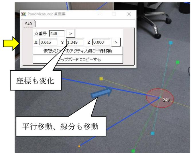
「クリップボードにコピーする」ボタンを押すと、選択されている点の座標をクリップボードに記録することができます。
