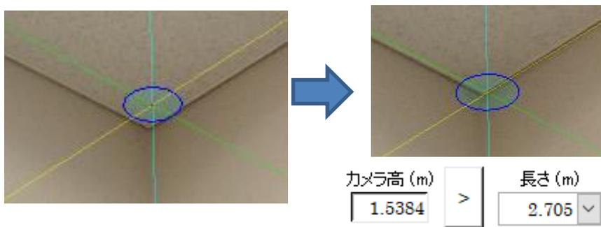
水色円盤の位置が天井面の角位置に来るように調整してください。
