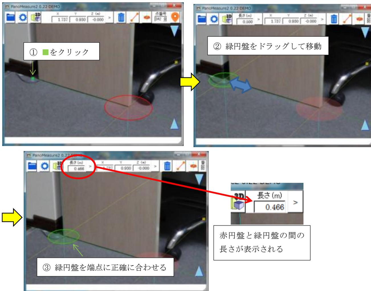
緑円盤を計測したい対象物のエッジの反対側の端点に正確に合わせてます。緑円盤にも赤円盤と同じように緑軸に対して直交する2つの軸(黄色、水色)が現れるので、それらの軸を使ってエッジなどに沿うように正確に合わせてゆきます。メニューバーの「長さ(m)」に長さが表示されます。
