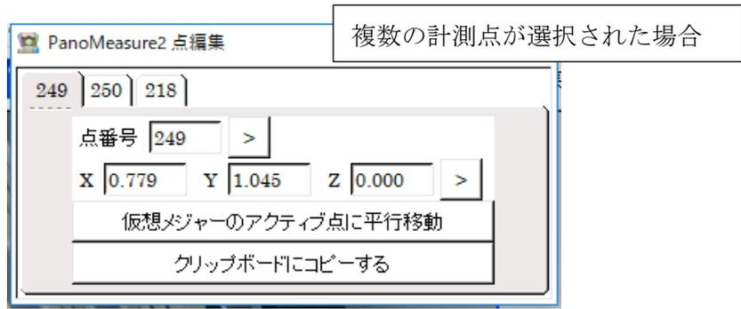
また、「仮想メジャーのアクティブ点に平行移動」ボタンを押すと、仮想メジャーの上のアクティブな円盤の中心位置に編集している点が移動します。
